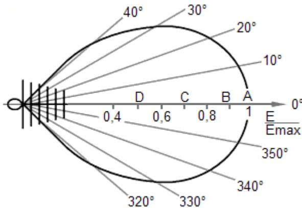
Die den Öffnungswinkel einschließenden Schenkel gehen durch die Punkte des Richtdiagramms, die 70,7% der maximalen Feldstärke entsprechen.
