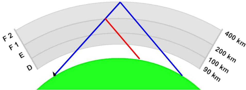
Wenn die Signale schon an der F1-Schicht absorbiert oder reflektiert werden, sind keine so großen Reichweiten, wie über die F2-Schicht erzielbar.
