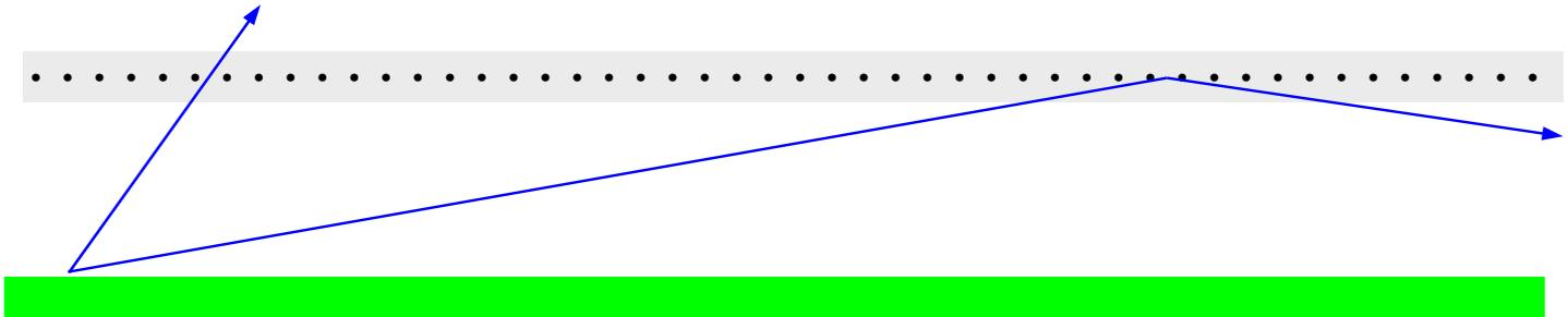
Die Ionosphäre sei ein Gitternetz, das uns in der Ferne immer engmaschiger erscheint. Auch unserem Funkstrahl geht es so. Steil nach oben gestrahlt, schlüpft er durch die Maschen. Flach abgestrahlt, wird er abgelenkt wie der flache Stein, den wir über's Wasser hüpfen lassen.
