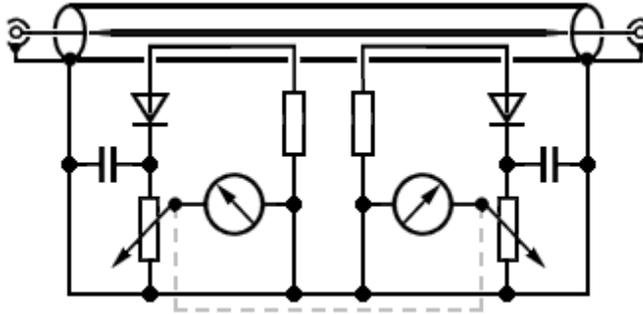
Reflektometer oder Stehwellen-Meßgerät.
