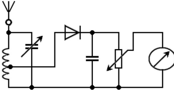
Die an der Hilfsantenne aufgenommene Energie wird vom (vorher geeichten) Schwingkreis selektiert.
