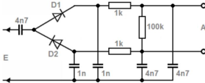
Der HF-Tastkopf wird z.B. einem Oszilloskop vorgeschaltet, damit Messungen an HF-Schaltungen vorgenommen werden können.
