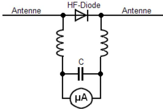
Die Diode richtet das von der Behelfsantenne empfangene Signal gleich. Die aus zwei Spulen bestehende Drossel und der Kondensator (C) entlassen in Richtung zum Meßgerät die feldstärkeabhängige Meßspannung, (Gleichspannung) die das Messgerät anzeigt. Ein (zumeist Eigenbau)- Hilfsmittel beim Aufbau einer Antenne.
