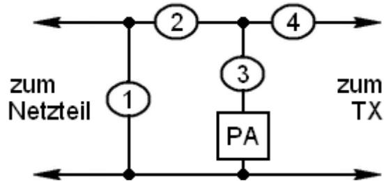
Spannungsmesser (1) werden **immer** parallel zum Meßobjekt, und **Strommesser** (2, 3, 4) **immer** in Reihe zum Meßobjekt angeschlossen.
