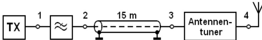
Direkt am Sender-Ausgang, zwischen Sender-Ausgang und Antennenanlage eingeschleift (in den Weg eingefügt), wird das Stehwellen-Meßgerät.
