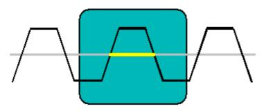
Angenommen das blaugrüne Feld sei der Bildschirm, dann wird klar, warum die Pulsbreite der Rechteckspannung bei der Null-Linie, bei 50% von **Uss** gemessen wird.
