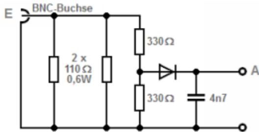
Alle Widerstände zusammen ergeben am Diodenanschluß 50 Ohm.
