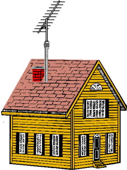
Eine außen angebrachte Fernsehantenne vergrößert das Nutzsignal des TV-Gerätes. Der Störabstand vergrößert sich damit ebenfalls.
