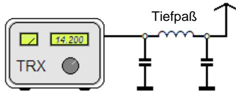
Oberwellen werden durch das Tiefpaßfilter unterdrückt.
