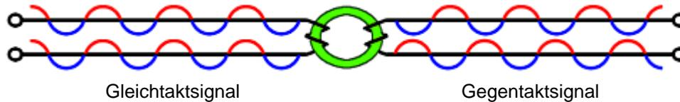
Mantelwellen sind Gleichtaktsignale auf einer Leitung. Das Kabel strahlt.
