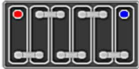
$$\text{Betriebsdauer } Bd = \frac{\text{Kapazität } 55 \text{ Ah}}{\text{Entnahme } 0.8 \text{ A}}$$
