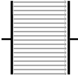
Ein homogenes elektrisches Feld ist ein gleichmäßiges, gleichförmiges elektrisches Feld.
