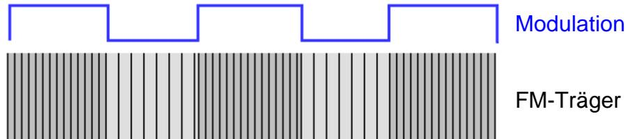
**FSK** = Frequency Shift Keying = Frequenz-Umschalt- Verfahren.
