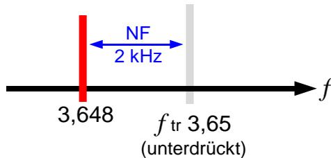
Hier wird in SSB mit einem  $-2$  kHz-Signal moduliert.
