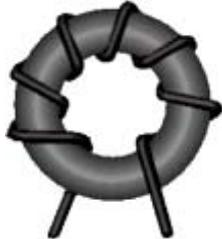
Ferritkerne sind z.B. Eisenpulver- bzw. Eisenoxyd- Kerne. Auch Netzdrosseln auf Ferritringkernen sind hochwirksam. Sie verstärken das Magnetfeld der Spule.
