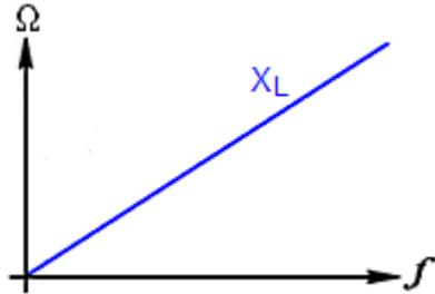
Wechselstromwiderstand  $X_L = \omega \cdot L$
