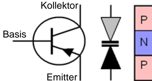
Nur die Emittordiode ist als Bezugs­elektrode im Schaltbild (links) angegeben, um Verwechslung mit der Kollektordiode (oberer Anschluß) zu vermeiden.
