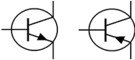
Der bipolare Transistor ist eigentlich nur ein Ventil, welches den Stromfluß eines leistungsfähigeren Stromkreises zwischen Emitter und Kollektor beeinflusst.
