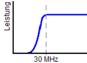
Der Kondensator wird erst bei hohen Frequenzen durchlässig.
