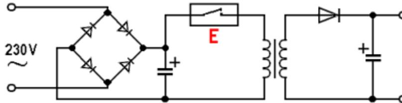
Ein Elektronischer Schalter **E** bestimmt eventuell die Pulsbreite des Ausgangssignals zur Festlegung der Ausgangsspannungshöhe.
