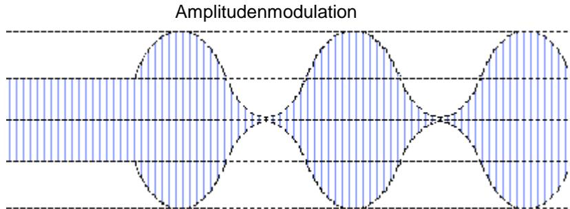
Die Modulations- Hüllkurve umschließt das hochfrequente Signal mit seinen vielen HF-Einzelschwingungen.
