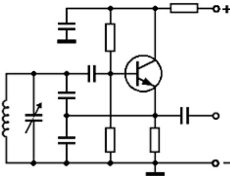
**Damit ungedämpfte Schwingungen** von Oszillatoren erzeugt werden führt man einen Teil der Schwingspannung zum Eingang zurück, der ausreichend stark sein muß, (Verstärkung  $\cdot$  Rückkopplung  $>$  1) um die Schwingung aufrecht zu erhalten.
