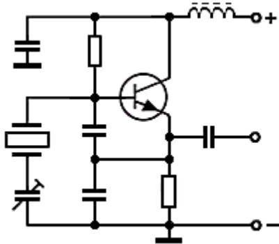
Quarzoszillatoren sind weniger temperaturempfindlich und daher sehr frequenzstabil.
