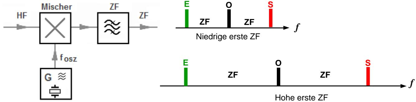
Je höher die erste ZF ist, umso weiter entfernt von der Empfangsfrequenz ist die Spiegelfrequenz.
