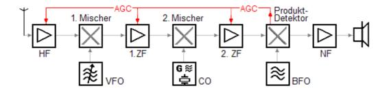
**AGC** = **A**utomatic **G**ain **C**ontrol = deutsch: AVR = Automatische Verstärkungsregelung.
