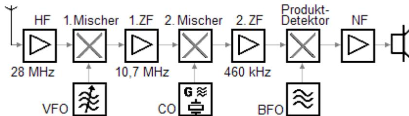
Der VFO:  $28 \text{ MHz} + 10,7 \text{ MHz} = 38,7 \text{ MHz}$
