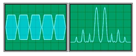
Das Signal wird in den Modulationsspitzen begrenzt. (Bild links) Die Spektrumanalyse zeigt zahlreiche Nebenprodukte. (Bild rechts). Die beiden großen Amplituden sind oberes und unteres Seitenband.
