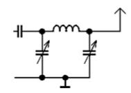
Oberwellenausstrahlung verhindert man mit einem Tiefpaß. Tiefpässe sind so gebaut, daß sich der Kondensator nie in der Signal-Leitung (oben) befindet.
