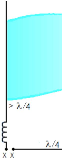
Bei längeren Antennen als  $5/8\lambda$  bildet sich eine weitere steilstrahlendere Strahlungskeule im Diagramm aus, und deren Energie geht verloren.
