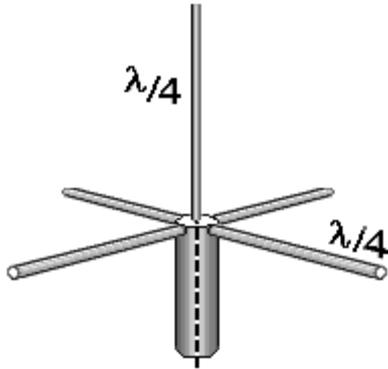
Die Radiale ergänzen die Antenne zu einem Halbwellenstrahler. Radiale heißen sie, weil sie radial vom Strahler weg angeordnet sind. Sie bilden ein Erdnetz nach.
