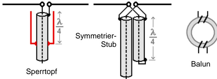
Außer mit einem Balun kann die Speisung der Antenne auch mit den hier vorgestellten Symmetriergliedern symmetriert werden.
