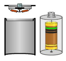
Eine Kunstantenne ist ein Sender-Abschlußwiderstand zu Testzwecken, der die Sende-Energie nicht nach außen dringen läßt. Sie wird in einem geschlossenen Gehäuse in Widerstände eingespeist, die die HF in Wärme umsetzen.
