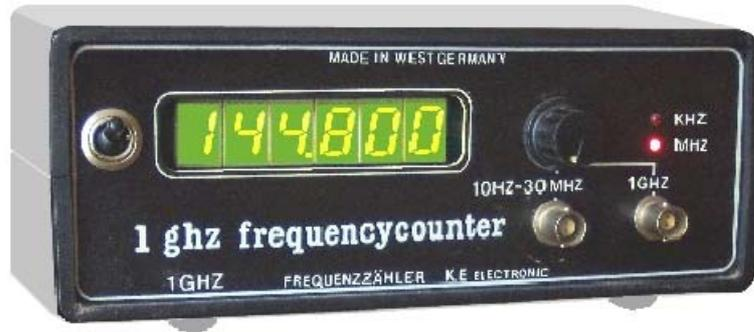
Frequenzzähler haben eine hohe Auflösung, und durch Quarzsteuerung eine große Genauigkeit um exakte Frequenzmessungen durchzuführen.
