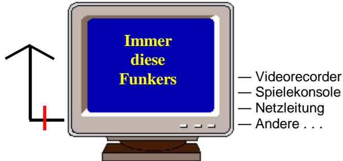
Festzustellen ist die Ursache, wenn von dem gestörten Gerät die Antenne entfernt wurde. Nun wird Kabel für Kabel entfernt, bis die Ursache gefunden ist.
